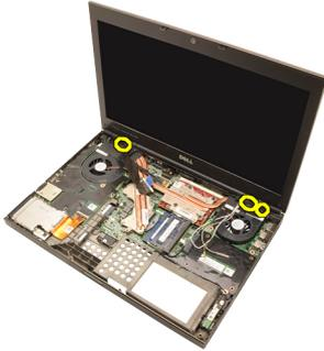
**18.** Extraiga el ensamblaje de la pantalla.
