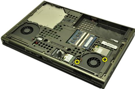
6. Retire el ventilador de la tarjeta gráfica del sistema.
