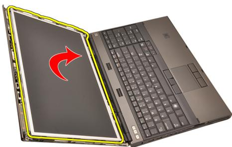
7. Despegue los adhesivos y desconecte el cable de señalización del diferencial de baja tensión (LVDS) de la parte posterior del panel de la pantalla.
