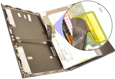
**8.** Desconecte el cable del digitalizador.
