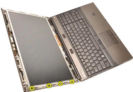
5. Apriete los tornillos de la parte derecha que fijan el panel de la pantalla.
