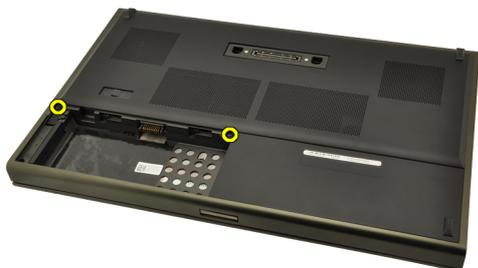
4. Presione las patas de goma hacia la parte posterior del sistema para soltar la puerta inferior.
