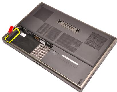
4. Desconecte el cable del Bluetooth de la tarjeta Bluetooth.
