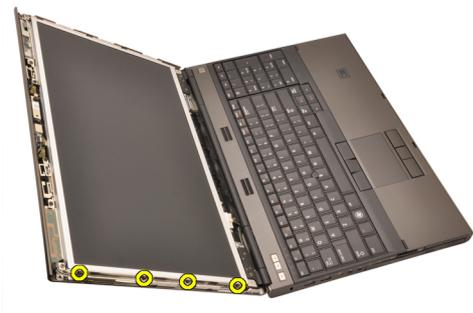
5. Apriete los tornillos de la parte derecha que fijan el panel de la pantalla.
