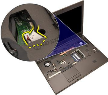
**18.** Levante el borde izquierdo del ensamblaje del reposamanos.
