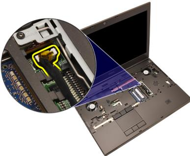
**16.** Desconecte el cable del lector de huellas dactilares.
