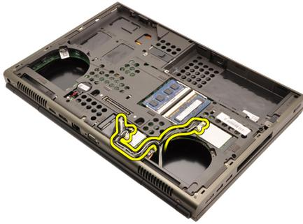
**13.** Afloje los cuatro tornillos cautivos (1 > 2 > 3 > 4) del disipador de calor.
