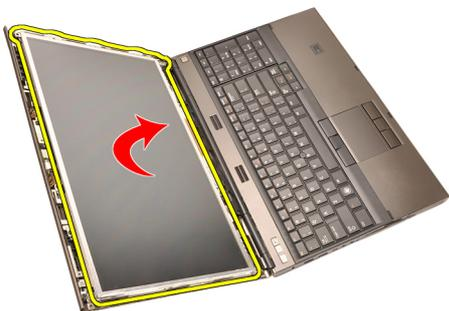
7. Despegue los adhesivos y desconecte el cable de señalización del diferencial de baja tensión (LVDS) de la parte posterior del panel de la pantalla.
