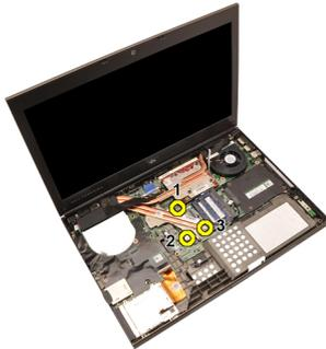
11. Levante el disipador de calor de la CPU y extráigalo del sistema.
