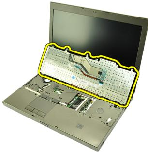
**8.** Quite la cinta adhesiva que sujeta el cable de datos del teclado a la parte posterior de éste.
