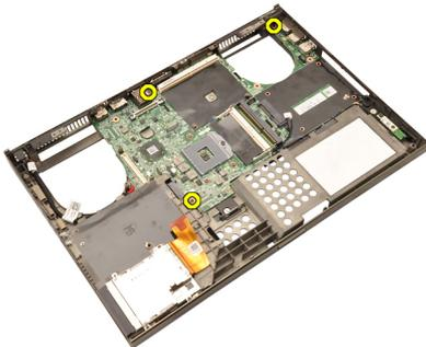
**28.** Levante con cuidado el borde inferior del ensamblaje de la placa base y sáquelo en un ángulo de 20 grados.
