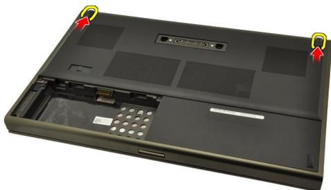
5. Extraiga la cubierta de la base del equipo.
