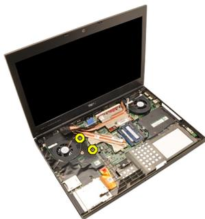
11. Levante el borde derecho de la placa de E/S para soltar el conector y sáquela del sistema.
