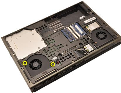
6. Retire el ventilador de la CPU del sistema.
