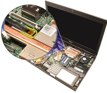
**17.** Quite los tornillos que fijan el ensamblaje de la pantalla.
