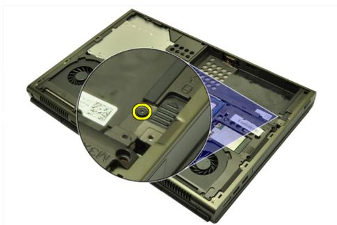
6. Deslice el pestillo de liberación de la unidad de disco duro a la posición de desbloqueo.
