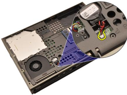
5. Levante la batería del adhesivo.
