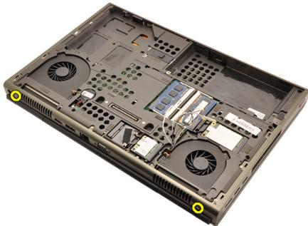
**13.** Pase las antenas a través de la abertura de la parte superior del equipo.
